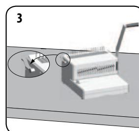
Asigurați-vă că clapeta de deschidere a pieptenelui este orientată în direcția posterioară.
