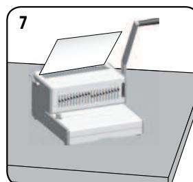
Încărcați foile perforate direct în pieptenele deschis.
