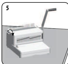
Introduceți pieptenele de plastic în mecanismul de deschidere. Trageți maneta de deschidere a pieptenelui pentru a deschide pieptenul.
