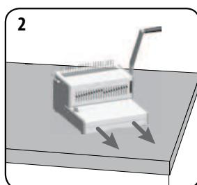
Casetă cu reziduuri trebuie să fie goală și instalată corect.
