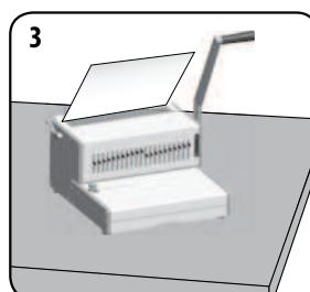
Încărcați foile perforate direct în pieptenele deschis. Începând cu partea frontală a documentului.
